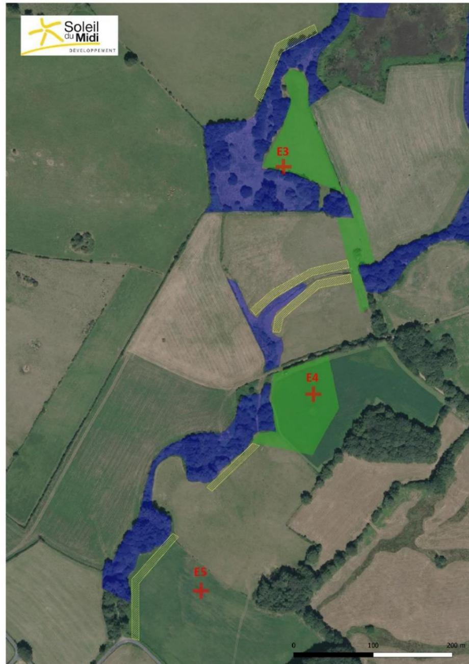
Figure 2 : Photo aérienne des terrains prospectés (en bleu : zones humides d'après le critère végétation ; en vert : zones à vérifier pour le positionnement des éoliennes ; en jaune : zones à vérifier pour les chemins d'accès ; croix rouges : positionnement des éoliennes)
